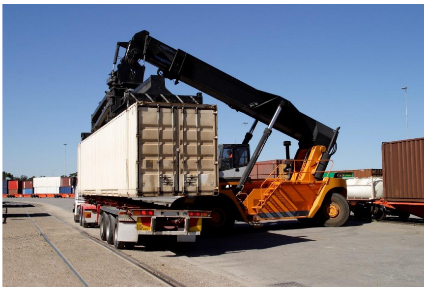
Figur 35. Exempel på intermodalitet, en container som flyttas mellan lastbil och tåg.
